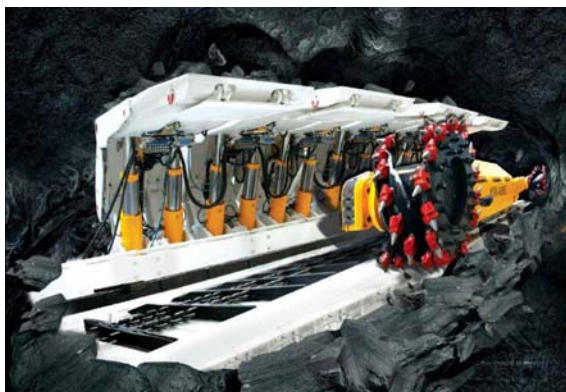
Zmechanizowany kompleks ścianowy dostarczony do KWK Pniówek (obudowy z TAGOR-u)
