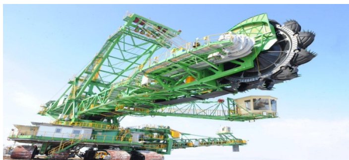
Koparka wielonaczyniowa, kołowa na podwoziu gąsienicowym KWK 1500.1
