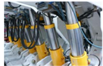
STOJAKI HYDRAULICZNE POKRYTE UNIKALNĄ WARSTWĄ POWŁOKI OCHRONNEJ DURACHROM
